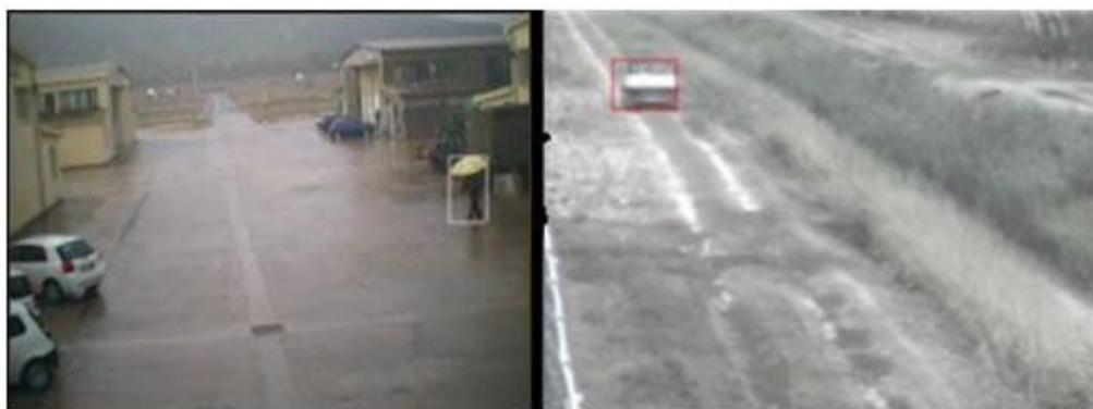
Rys. 7. Wykrycie intruza w wirtualnym obszarze nadzoru
